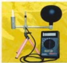
ТЕНЗОР-42 - прилад для автоматичного визначення індексу теплового навантаження середовища (ТНС – згідно із стандартом ISO 7243
