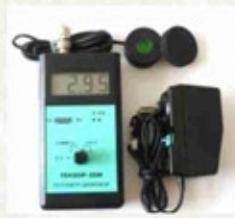
ТЕНЗОР-26М - призначений для вимірювання сили світла зовнішніх світлових приладів дорожніх транспортних засобів та інших точкових джерел світла.
