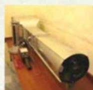
ТЕНЗОР - АТ-25 - aerodynamічна труба для відтворення потоку повітря в діапазоні від 0,1 до 20 м/с
