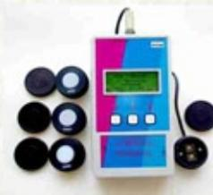
ТЕНЗОР-31 - радіометр енергетичної освітленості УФ-випромінювання
